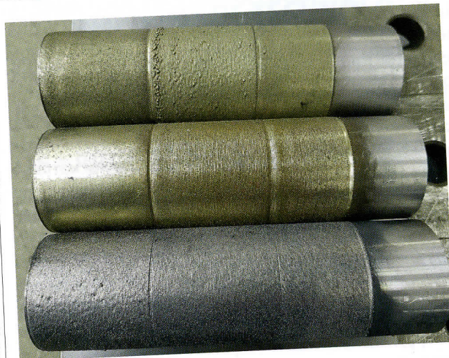
Рис. 3. Пробы с наплавленными слоями Fig. 3. Samples with deposited layers
