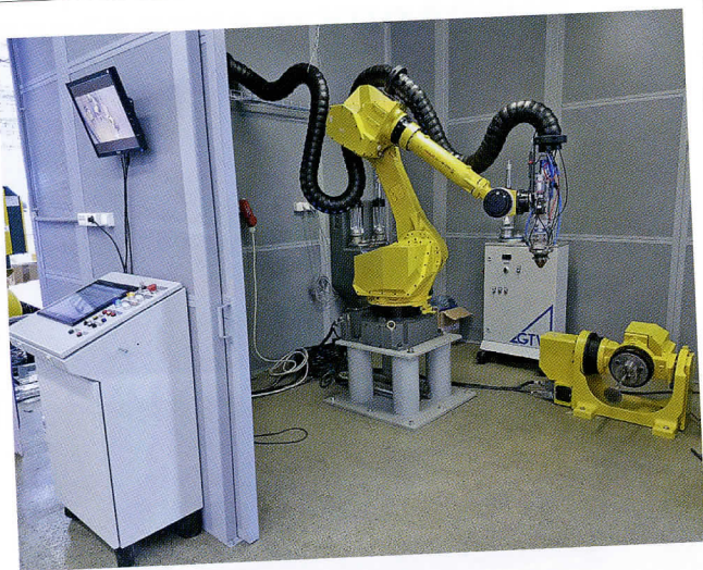
Рис. 2. Роботизированный комплекс порошковой лазерной наплавки Fig. 2. Robotic complex of powder laser deposition
