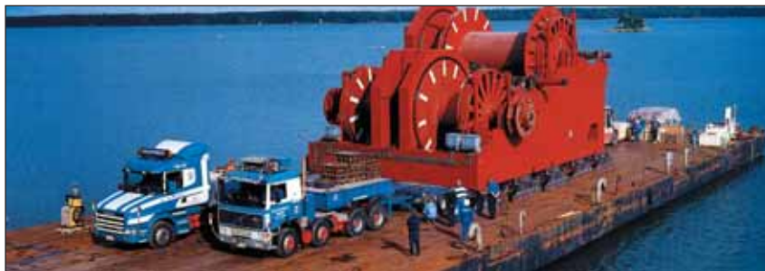
Подготовка к транспортировке на барже крупнейшей в мире судовой лебедки, развивающей усилие 6000 кН
