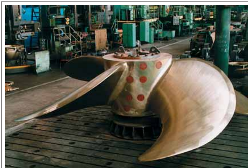
Один из гребных винтов диаметром 5,6 м и массой 28 т, изготовленный ГМП «Звездочка» для суперлайнеров типа «Eagle», перед отправкой заказчику. Статья о головном круизном лайнере этого типа « Youager of the Seas » — на стр. 63—65. ГМП «Звездочка» производит цельнолитые и сборные гребные винты из высокопрочных нержавеющей сталей, углеродистых сталей, цветных и титановых сплавов. Масса гребных винтов от 50 кг до 50 т. Диаметр цельнолитых винтов от 1 до 3,5 м, сборных и ВРШ — от 1,5 до 7 м. Фото В. Г. Николаева
