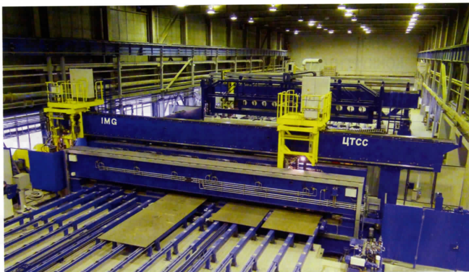
Фото 2. Линия изготовления плоских секций с использованием лазерной резки и гибридной лазерно-дуговой сварки
