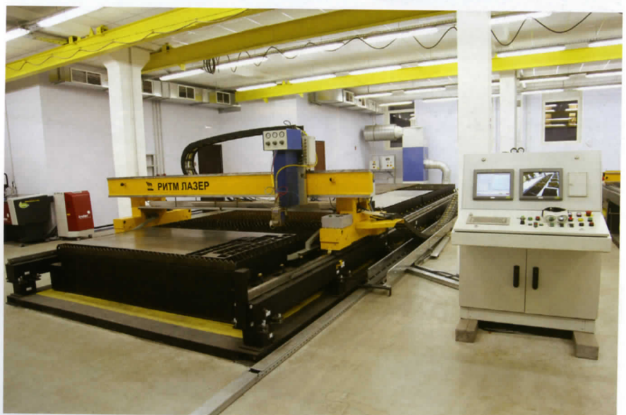
Фото 1. Промышленный комплекс лазерного раскроя металлопроката «Ритм лазер»
