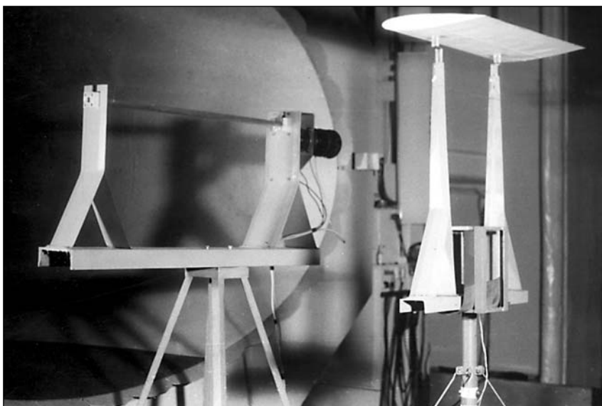
Рис. 1. Испытания модели крыла в аэродинамической трубе
