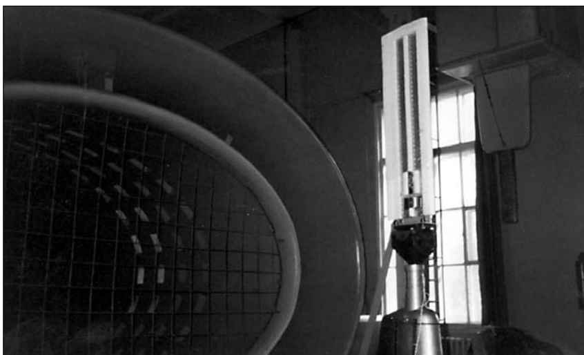
Рис. 3. Экспериментальные исследования в аэродинамической трубе влияния вибрации крыла на его аэродинамические характеристики
