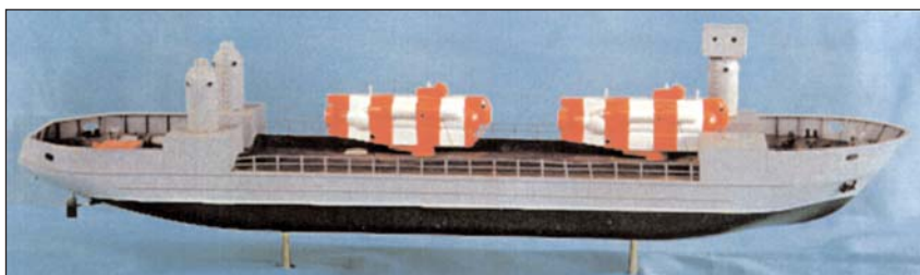
Погружающееся судно подводно-технических работ (проект) способно нести два ПА общей массой до 110 т и обеспечивать их спуск и подъем. Нормальное водоизмещение (без ПА) 2100 т (модификация — 1300 т), длина 85 м (61 м), ширина 11,6 м, осадка 2,7 м (2,5 м), скорость 15 уз (10 уз), дальность плавания 3600 миль (1000 миль), экипаж 44 чел. (35 чел.). Глубина погружения ПА — 100 м, работы водолазов — 300 м (100 м)
