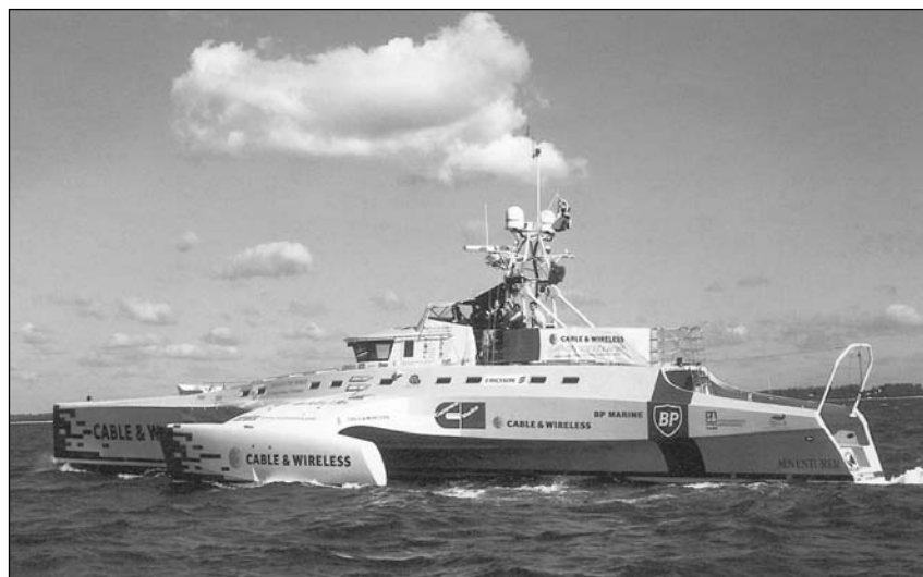
Рис. 3. Судно «Cable & Wireless Adventurer» с двумя аутригерами, поставившее мировой рекорд скорости в кругосветном плавании
