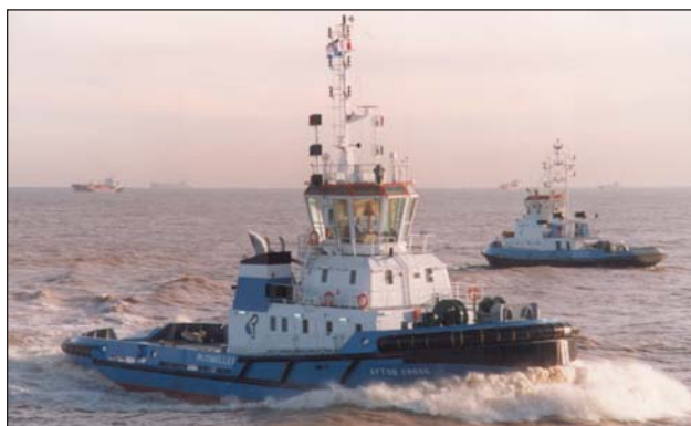
«Ayton Cross» — один из двух буксиров, построенных в конце 2000 г. испанской верфью Astilleros Zamacoа для компании Wijsmuller Marine. Буксир снабжен полноповоротной винторулевой колонкой, имеет усилие на гаке 600 кН и будет эксплуатироваться в английском порту Хартлпул
