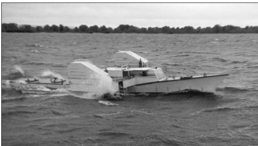
Рис. 2. Полунатурная модель в процессе испытаний на открытой акватории
