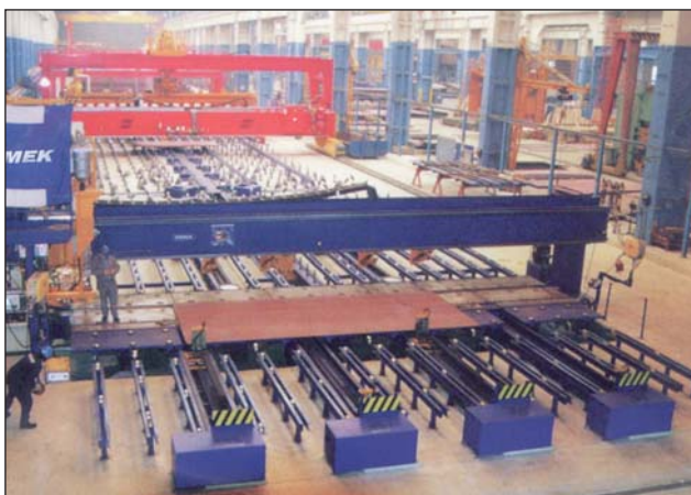
Автоматизированная линия для изготовления плоскостных секций, поставленная фирмой Pematек в Германию
