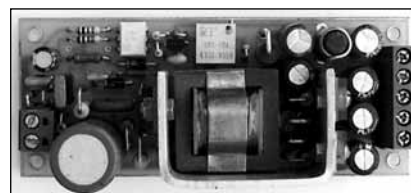
Рис. 3. Импульсный источник питания MIDDLE-30 мощностью 30 Вт, U_{вх} = 27 В , U_{вых} = +5, \pm 18 В
