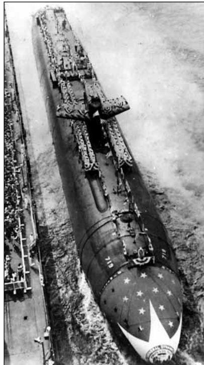
Спуск на воду атомной подводной лодки «Providence» — первой лодки типа «Los Angeles» с вертикальными пусковыми установками для крылатых ракет «Tomahawk», 1984 г.
