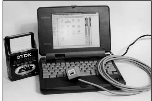
Рис. 6. Автономная компьютеризированная система видеоконтроля в составе универсальной видеоголовки, встроенного модуля АЦП, компьютера COMPAQ/Notebook и программного обеспечения
