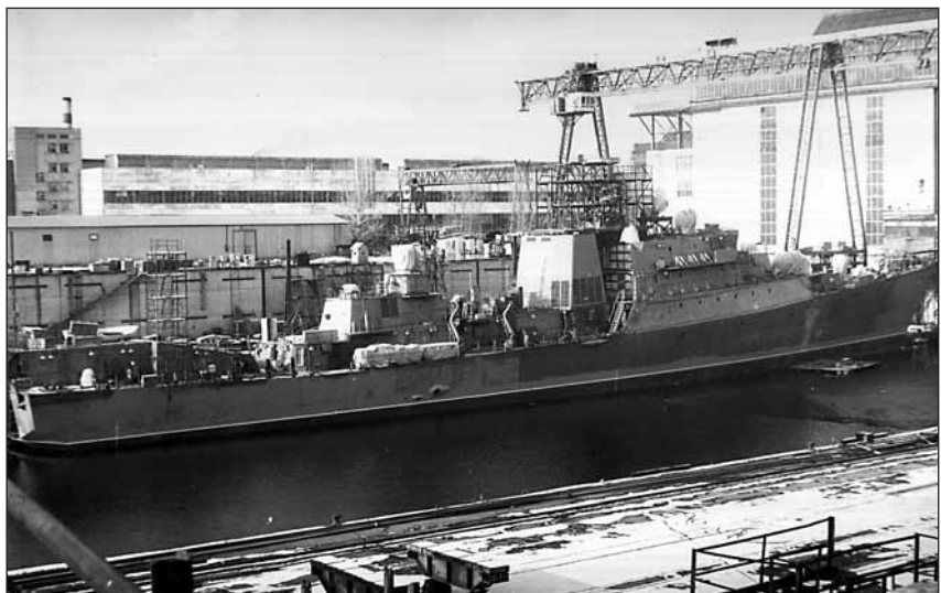
Постройка сторожевого корабля пр. 11661 («Гепард»)
