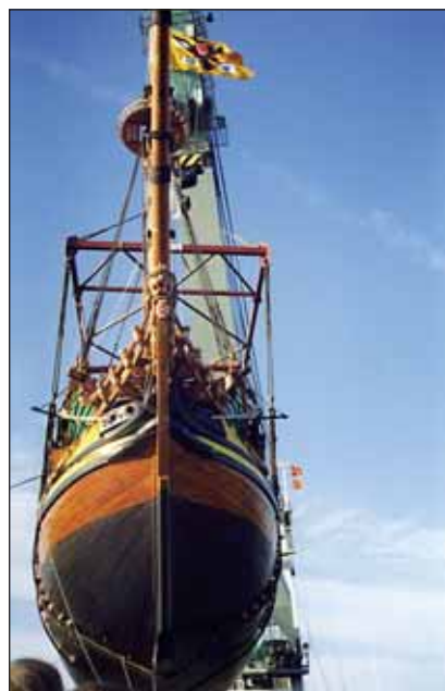
Корабль на стропях плавкрана «Богатырь-4»
