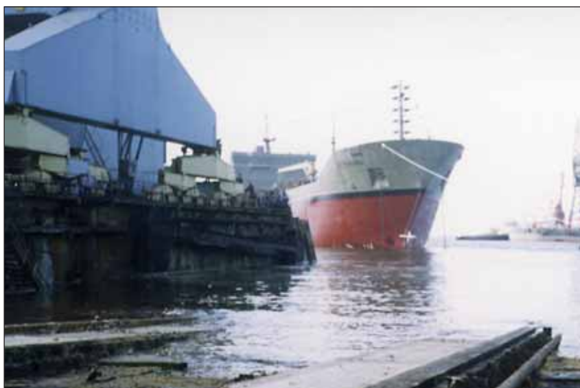
Головной танкер-продуктовоз «Астрахань» дедевейтом 20 000т после спуска на воду с наклонного стапеля ГУП «Адмиралтейские верфи»
