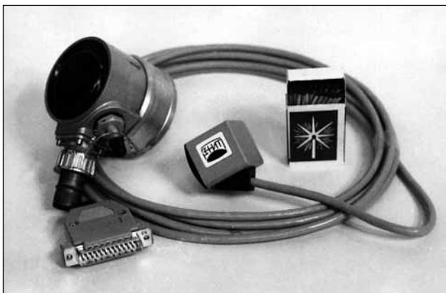
Рис. 2. Внешний вид микровидеоголовки ЭВК-103МС (слева для сравнения по габаритам показан аналоговый датчик давления ЭДД-100)
