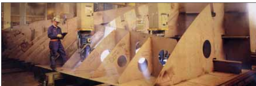
Роботизированная сварка корпусных секций на датской верфи Odense Steel Shipyard
