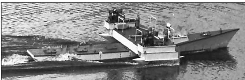
Рис. 1. Полунатурная модель корабля, предложенного С.А.Руденко, на открытом водоёме
