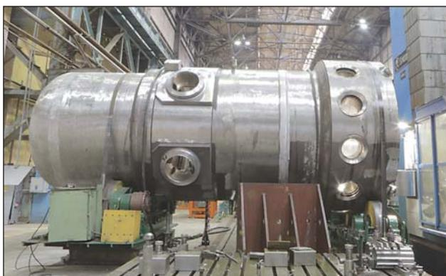
Корпус реактора энергетической установки «РИТМ-200» для головного атомного ледокола нового поколения ЛК-60Я проекта 22220
