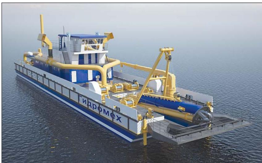
Проектное изображение земснаряда, разработанного конструкторами ЗАО «Завод гидромеханизации»
