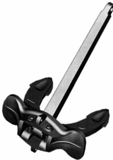
Рис. 4. Электронная модель якоря Холла, разработанная в CADKEY
