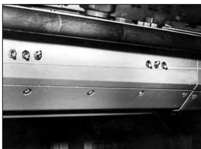
Рис. 3. Передняя панель пульта с установленными на ней переключателями для изменения старшего разряда вызывного номера контролируемого параметра. (Три левых тумблера — для БУИТ ППУ, три правых — для БУИТ ПТУ)
