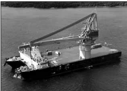
Транспортно-монтажное крановое судно типа «Титан» катамаранного типа с краном грузоподъемностью 600 т. В 1984—1986 гг. построено четыре таких судна
