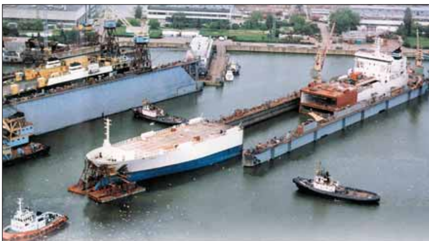
Удлинение финского ролкера «Finnoak» на литовской верфи Vakarų laivų remontas (Western Shiprepair Yard) в Клайпеде осуществлено в апреле—июле 1998 г. с участием петербургской судостроительной компании «АКО БАСС»
