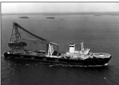
Крановое судно «Станислав Юдин» с краном грузоподъемностью 1600 т построено в 1985 г.
