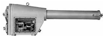
Рис. 7. Палубное пусковое устройство с дистанционным управлением для зонда «Алтын»
