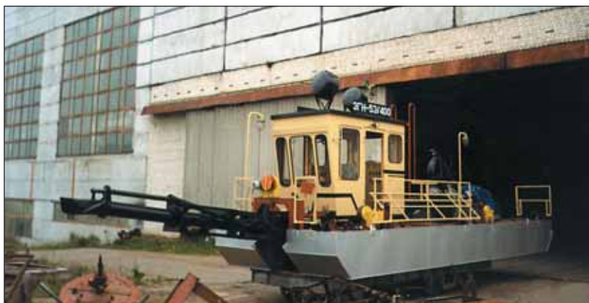
Малогабаритный земснаряд ЗГН-5Э/400, построенный на Опытном заводе в Шлиссельбурге
