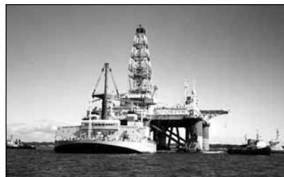
Заводка ППБУ «Шельф-6» на судно типа «Траншельф» (построено в 1987 г.) для перевозки на палубе СПБУ, ППБУ и др.
