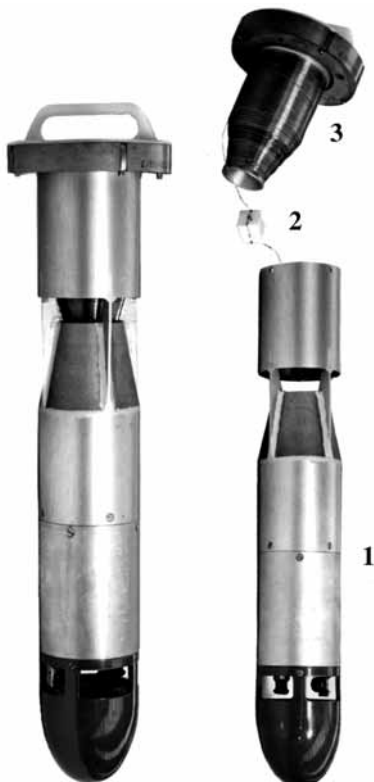
Рис. 2. Внешний вид разового зонда типа «Алпйн» для измерения ВРСЗ и его основных компонентов: 1 — зонд; 2 — поплавок; 3 — бортовая катушка
