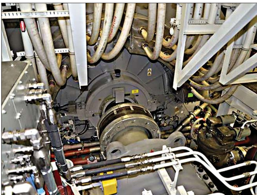
Асинхронный ГЭД ЭМ УРО типа «Zumwalt»
