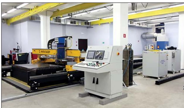
Рис. 1. Промышленный комплекс лазерного раскроя металлопроката «РИТМ-Лазер»
