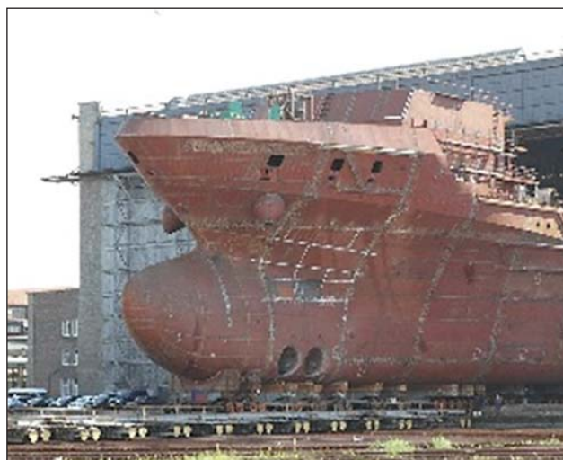
Судно тылового обеспечения «Всеволод Бобров» в процессе перемещения из эллинга на открытый стапель ОАО СЗ «Северная верфь»
