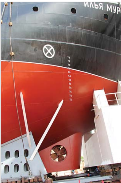
Носовое подруливающее устройство
