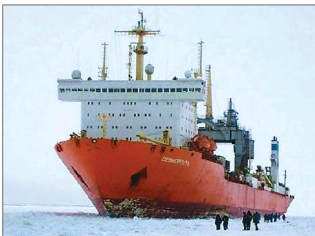
Лихтеровоз «Севморпуть». Основные характеристики: длина 260, ширина 32,2, высота борта 18,3, осадка 11,8 м, водоизмещение 61880 т, ледопробитность 1,5 м
