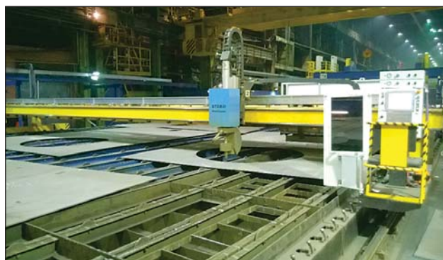
Рис. 2. Широкопортальная машина с ЧПУ для контуровки плоских секций
