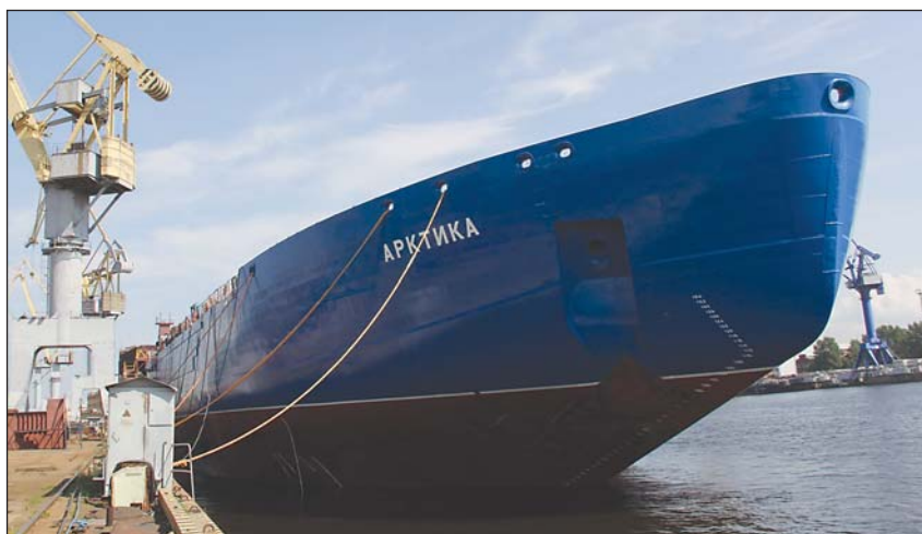
Головной атомный ледокол «Арктика» пр. 22220 у достроечной набережной ООО «Балтийский завод – Судостроение». Основные характеристики: длина 173,3, ширина 34, осадка 10,5/8,55 м, водоизмещение 33540/25540 т, ледопробитность 2,9/2,4 м. Мощность на валах 60 МВт, дальность плавания неограниченная
