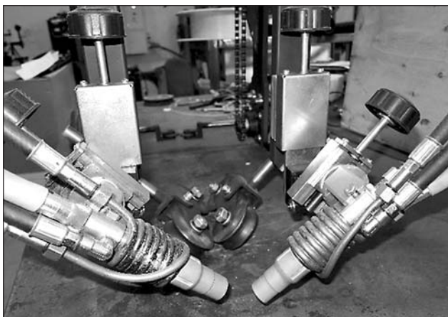
Рис. 10. Автомат для двухсторонней приварки набора
