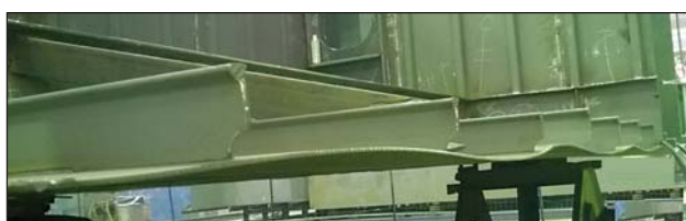
Рис.3. Деформации секций корпусов судов при дуговой сварке
