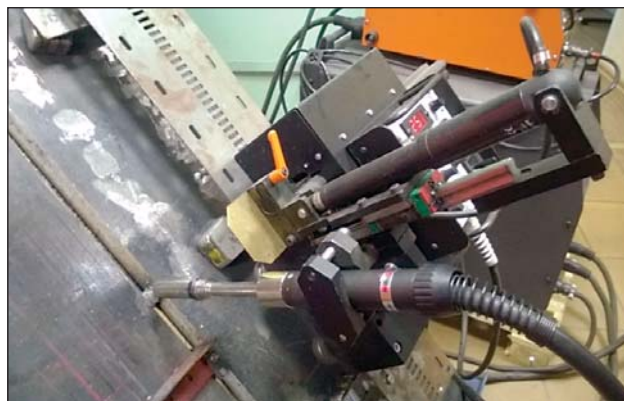
Рис. 11. Автомат для сварки монтажных соединений блоков судов во всех пространственных положениях из сталей толщиной от 8 до 60 мм
