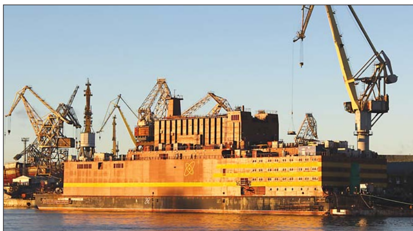
Плавучий энергетический блок «Академик Ломоносов». Основные характеристики: длина 144, ширина 30 м, водоизмещение 21 500 т
