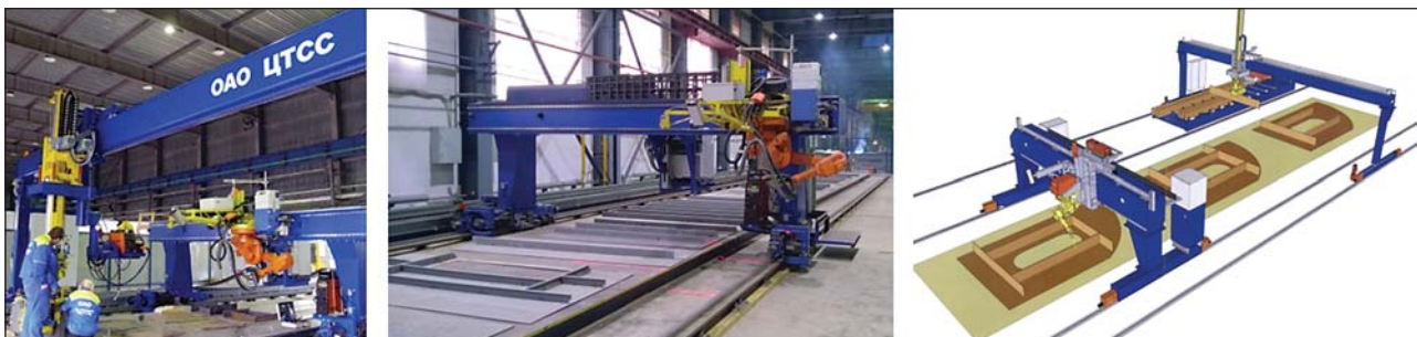
Рис. 7. Роботизированный комплекс сборки и сварки микропанелей
