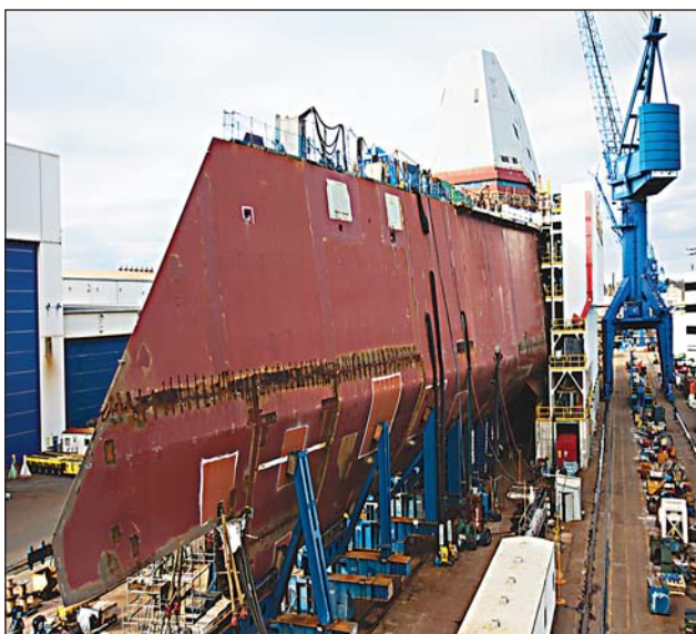
Блочная сборка ЭМ УРО «Zumwalt»
