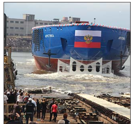
Резка задержника — последней связи ледокола с берегом
