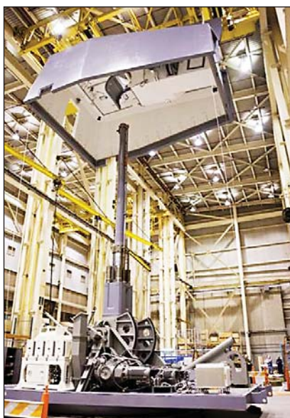
Артиллерийская установка AGS калибра 155 мм
