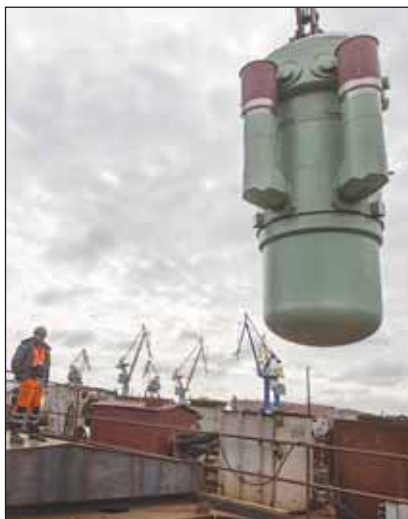
Погрузка на головной атомный ледокол «Арктика» второго парогенерирующего блока реакторной установки РИТМ-200
