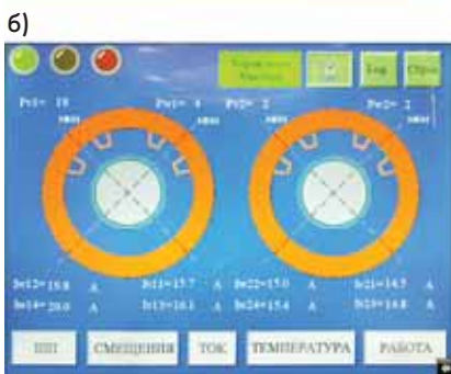
Рис. 8. Индикация положения ротора гребного электродвигателя: а — на опорных подшипниках, б — в рабочем состоянии
