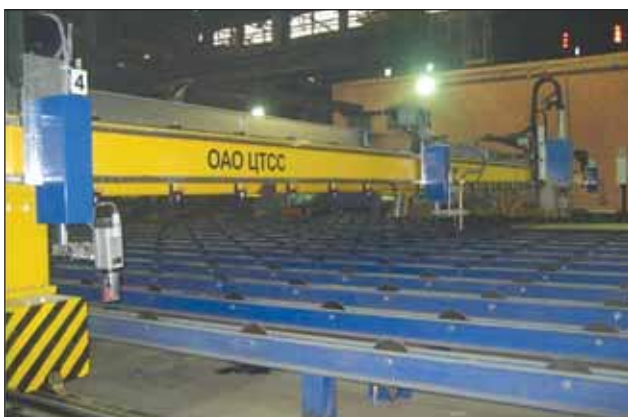
Рис. 1. Многофункциональная машина термической резки для контурки полотнищ плоских секций «Ритм-М ППлКП-12 3D»
