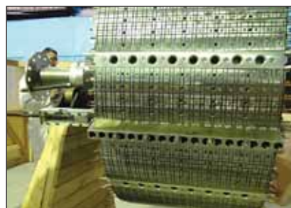
Рис. 6. Ротор гребного электродвигателя с возбуждением от постоянных магнитов
