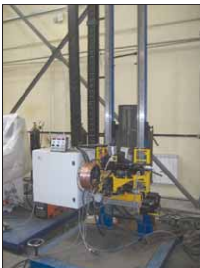
Рис. 3. Автомат «Вертикаль-С» для стыковой сварки обечаем прочного корпуса
