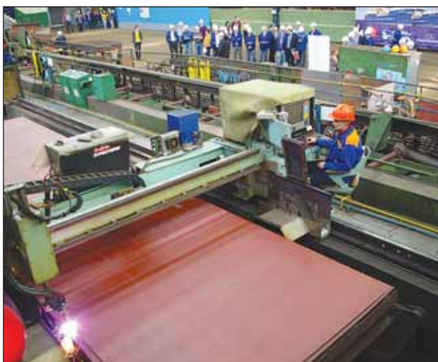
Плазменная вырезка деталей корпуса рыболовного траулера-сейнера в цехе АО «ПСЗ «Янтарь»
