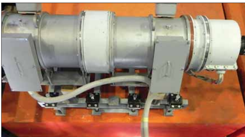
Рис. 19. Общий вид макета вспомогательного генератора мощностью 500 кВт при 6000 об/мин для питания корабельной нагрузки напряжением 3 \times 380 В с частотой 50 Гц
