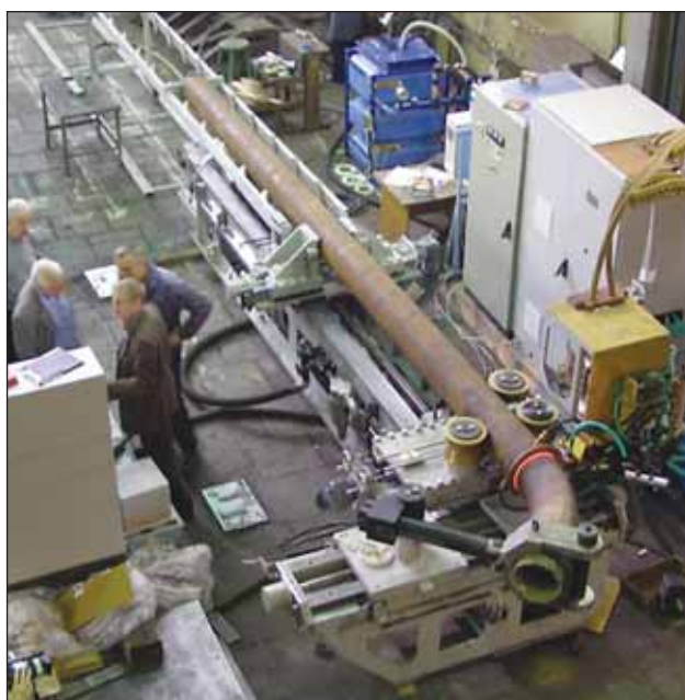
Рис. 4. Установка УТГ-ИН-273 для гибки труб с индукционным нагревом
