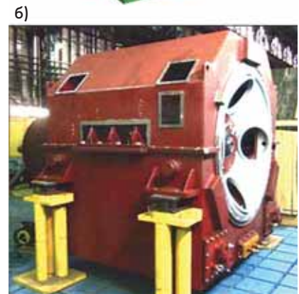
Рис.10. Гребной электродвигатель: а — компьютерная модель; б — реальный собранный образец
