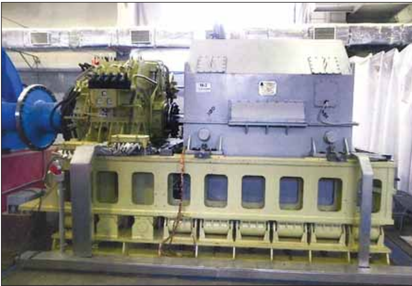
Рис. 11. Общий вид изготовленного электроредукторного агрегата, установленного на стенде
