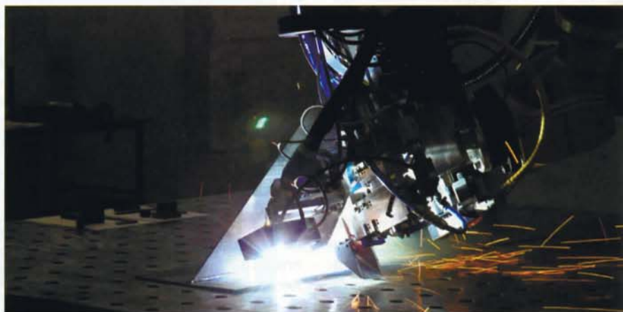
Рис. 1. Роботизированное оборудование для сварки корпусных конструкций
