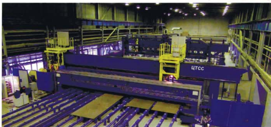
Рис. 2. Линия изготовления плоских секций
