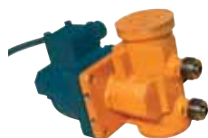
Распределитель пневматический трехходовой штуцерный с электромагнитным и ручным приводом Dy 6 мм, Рр 2,5–5,5 МПа Проводимая среда — воздух
