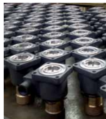
Кингстон из спецсплава с гидроприводом и ручным управлением Dy 200 мм, Ру 10,0 МПа Проводимая среда — морская вода
