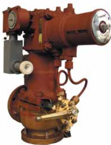
Клапан бронзовый запорный угловой с гидроприводом и ручным управлением Dy 150 мм, Ру 4,0 МПа Проводимая среда — морская вода
