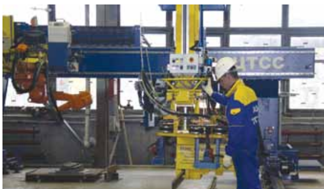
Захват ребра жесткости манипулятором
