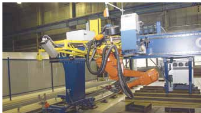
Портал для лазерного сканирования, фотограмметрирования и роботизированной приварки ребер жесткости микропанелей
