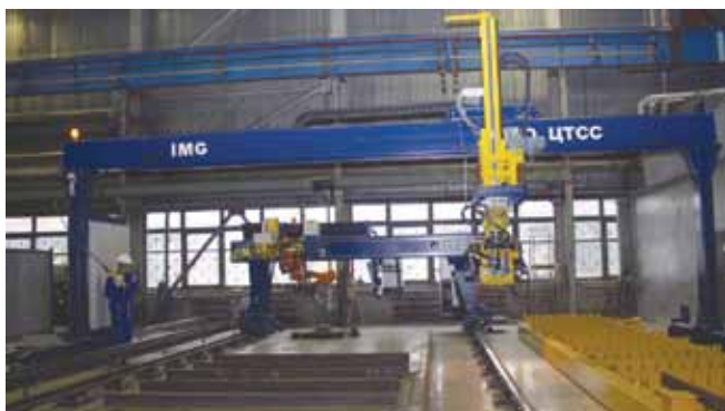
Портал для механизированной установки и прихватки ребер жесткости на полотна микропанелей
