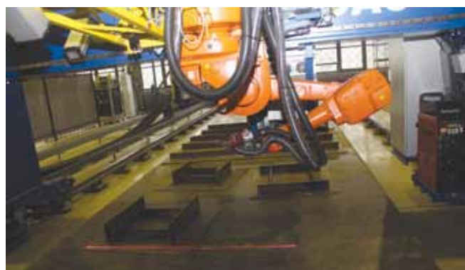
Процесс лазерного сканирования с фотограмметрированием
