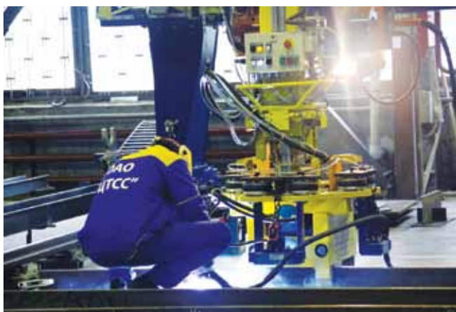
Прихватка ребра к полотну микропанели
